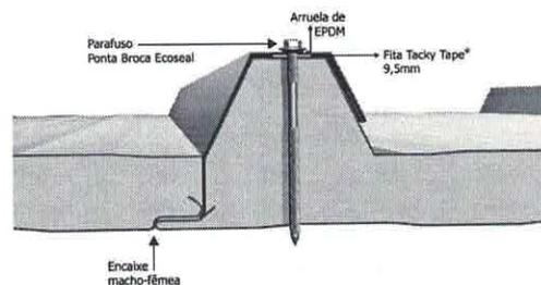
A fixação na onda alta garante a estanqueidade.
